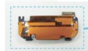
メイン・アンテナ(裏側) W-CDMA, GSM用
