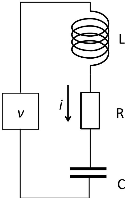
L,R,Cの各素子にかかる電圧を $v_L$ ,  $v_R$ ,  $v_C$ とする。それぞれの電圧は、共通に流れる電流*i*と次の関係にある。
